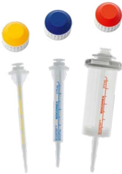
Drei Spritzengrößen decken den gesamten Volumenbereich von 10 bis 5000 µl ab. Die Farbcodierung der Direktverdängungs-Spritzen und des Einstellknopfes eliminiert jeden Einstellungsfehler. Die Graduierung hilft bei der Kontrolle des Spritzeninhalts. Erhältlich als sterile und non-sterile *bioproof™* Versionen. Kompatibel mit allen Stepper™-Generationen.
