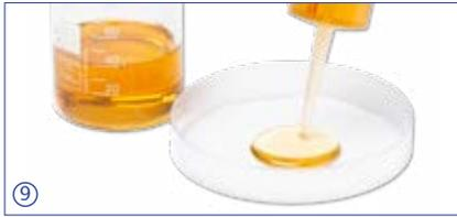
Die Ecostep™ Direktverdrängungs-Spritzen vermeiden direkten Flüssigkeitskontakt mit der Repetierpipette. Chemikalien wie Säuren, Basen, Lösungsmittel und schäumende Flüssigkeiten sowie viskose und hochdichte Reagenzien können leicht verteilt werden.
