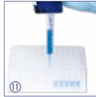
Der Stepper™ eignet sich am besten für die Aufteilung von Proben in kleine Einheiten, für präzises Dispensieren in Röhrchen und Flaschen oder für Screening-Verfahren.
